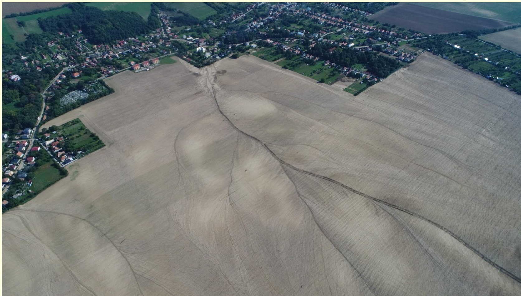
Pohľad na erodovaný pôdny blok 8 dní po bleskovej povoodni (11.9.2018)
