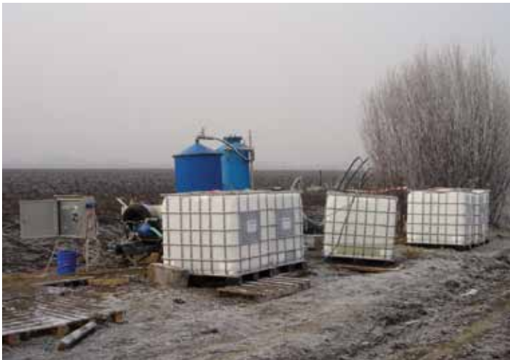
Obr. 5.1.10. Piešťany, areál bývalej Tesly – sanačná jednotka, príprava roztoku kyseliny mliečnej (foto ENVIGEO, a. s.).
