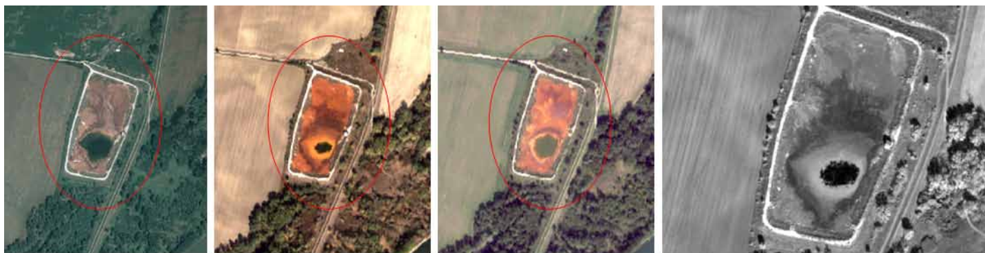
Obr. 2.4.3. Príklad využitia metódy DPZ – skládka železitých kalov Šulekovo (Gregor, 2008).
