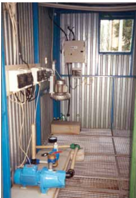
Obr. 5.1.18. Pohľad do vnútra sanačnej jednotky, katalytický oxidízér určený na čistenie vzduchu zo stripovacích veží (foto HES-COMGEO, spol. s r. o.).
