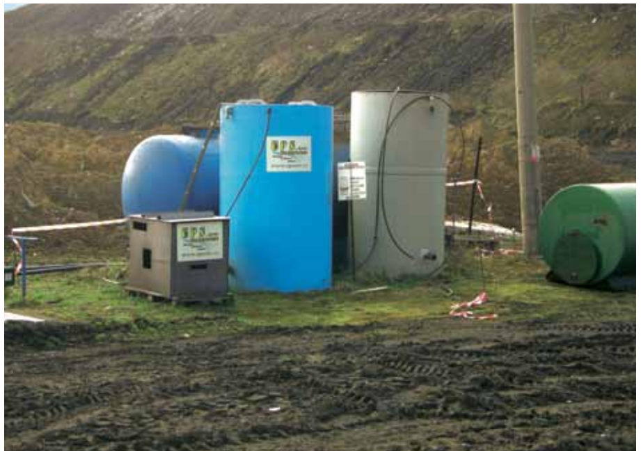
Obr. 5.2.5. Litvínov, areál skládky spoločnosti Celio, a. s. – sanačná jednotka, v pozadí znečistená zemina pripravená na dekontamináciu (foto EPS, spol. s r. o.).
