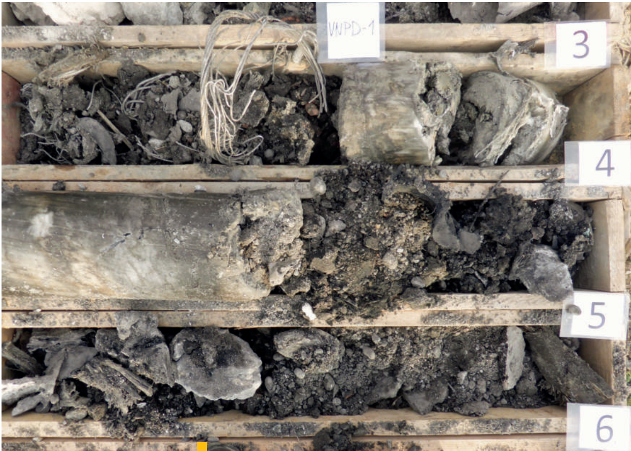
5 Profil vrtného jadra z vrtu VNPĐ-1 (3 – 6 m p. t.) – materiál starej časti skládky
