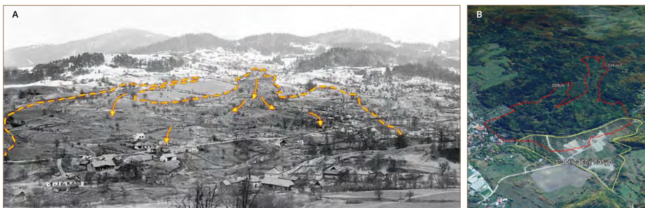
Obr. 5.2: Pohľad na handlovský zosuv; A – foto z obdobia jar 1961; B – súčasný stav so stabilizačným násypom ako sanačným opatrením (zostavil P. Ondrus)
