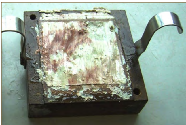
Obr. 9.29: Vzorka zeminy zo šmykovej plochy v krabicovom a kruhovom šmykovom prístroji po ukončení skúšky (foto: M. Kopecký)
