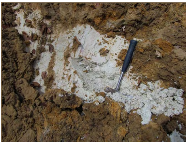
Obr. 9.28: Detail šmykovej plochy z Kraľovianskeho zosuvu (foto: M. Ondrášik) a šmykovej plochy zo zosuvu v Šenkviach (foto: V. Jánová)
