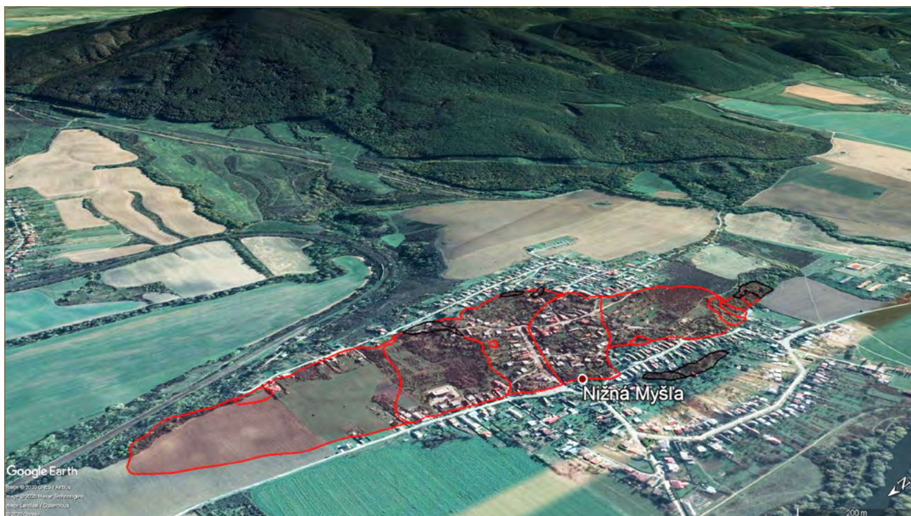
Obr. 8.64: Rozsah porušenia územia obce Nižná Myšľa (Ondrus, 2020)
