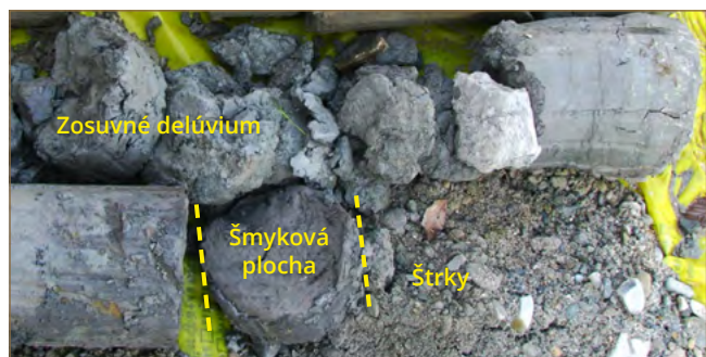
Obr. 9.22: Záchytená šmyková plocha vo vrtnom jadre na kontakte ílovitých delúvií a štrkov aluviálnej nivy – Vrt V-2 (Kopecký, 2010)
