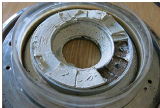
Obr. 9.29: Vzorka zeminy zo šmykovej plochy v krabicovom a kruhovom šmykovom prístroji po ukončení skúšky (foto: M. Kopecký)
