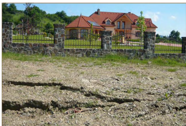
Obr. 9.5: Otvorené trhliny na zosuvoch v Kapušanoch a vo Veľkom Krtíši (foto: V. Jánová, P. Ondrejka)
